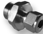
Typ RCI Edelstahlflansch mit Klemmverschraubung und G1/2" Gewinde für Fühlerdurchmesser : Ø3, Ø6, Ø8, Ø12, Ø13, Ø14 mm
