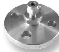
Typ DIN/RCCT Edelstahlflansch mit Klemmverschraubung nach DIN 2566 für Fühlerdurchmesser : Ø8, Ø13 mm
