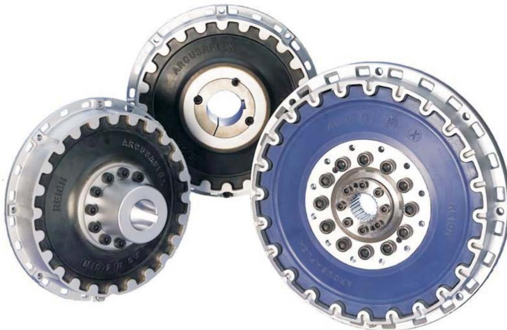
Die ARCUSAFLEX-Flanschkupplungsbaureihe umfasst Baugrößen für einen Drehmomentbereich von 200 - 110000 Nm (entsprechend ca. 6500 kW bei 1000 min<sup>-1</sup>). Zur Abstimmung der günstigsten Drehschwingungslage sind Elementausführungen mit verschiedenen Drehfedersteifen lieferbar. Die Flanschanschlussmaße der ARCUSAFLEX-Kupplungen entsprechen vorwiegend der SAE-Norm J 620 bzw. DIN 6281. Abweichende Flanschmaße und Bau-längen sind auf Wunsch lieferbar.
