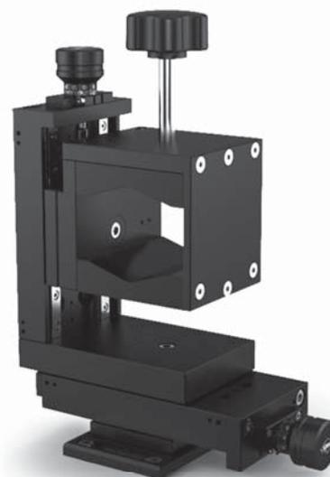
Die Laserjustierungen LJ 80 bestehen aus einer prismatischen Spannaufnahme, die linear in zwei Achsen, quer zur Strahlrichtung ausgerichtet und um zwei Achsen geschwenkt werden kann.
