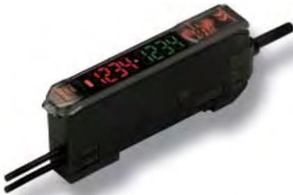
Der digitale Lichtleiterverstärker E3X-DA-AT-S mit aktivem Schwellwert kompensiert die durch Schmutz verursachte Verringerung der Lichtstärke und gewährleistet eine stabile Funktion.
